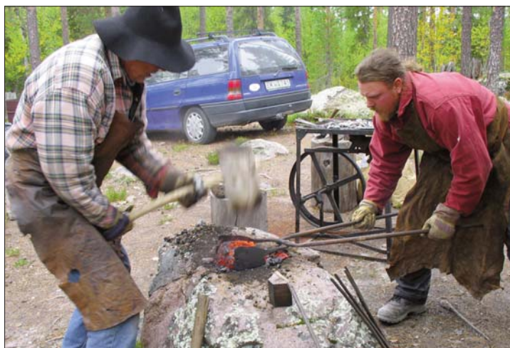
Järnluften befrias från slagg och orenheter som försämrar kvaliteten på järnet
