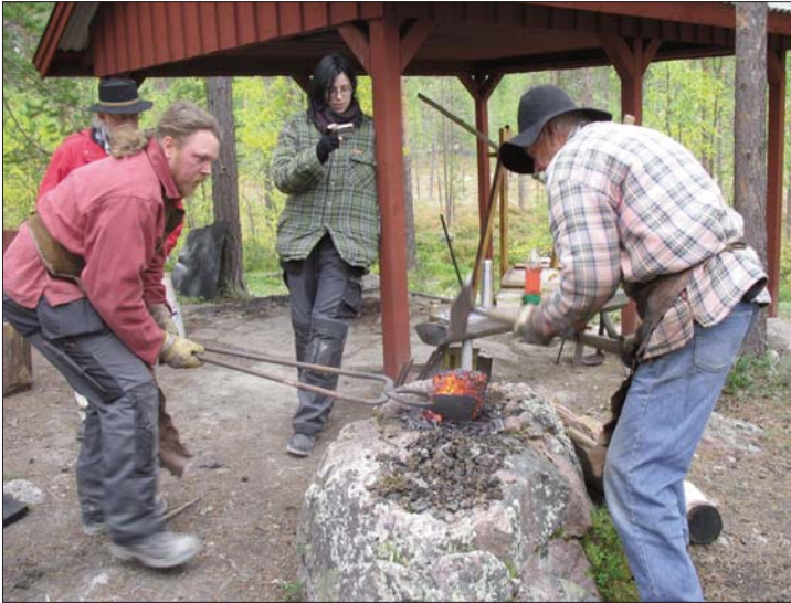
5. När temperaturen nått över 1000 grader tas järnluppen upp och bearbetas för att få bort kvarvarande slagg och göra järnet smidbart.
