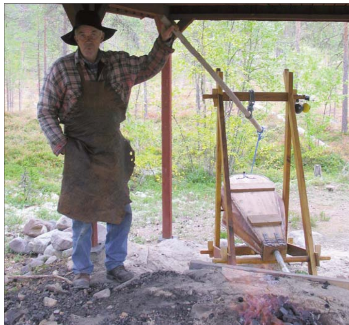
3. För att uppnå en temperatur på över 1000 grader grävs ständigt tillförsel av syre. Syret tillförs genom en stor bälg som drivs för hand eller vattenkraft där sådan finns.
