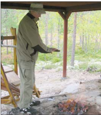
2. Malm och glödande kolv ved tillförs i gropen som sedan får brinna tills temperaturen nått över 1000 grader.
