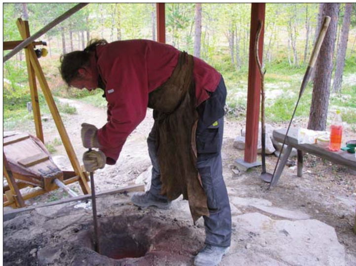
1. En grop grävs i jorden och klär den sedan med lera runt om. Ugnen förvärms med ved sedan fyller man på med myrsmalm och fyller sedan ugnen med brinnande kol som sedan pressas upp i ca. tusen grader med en stor bälg som blåser in luft under den glödande kolen. Se skiss sidan 20.
