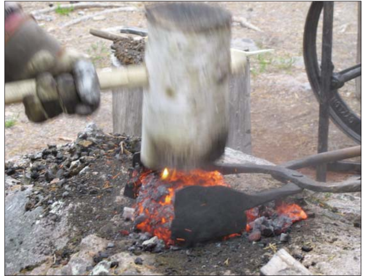
5. När temperaturen nått över 1000 grader tas järnluppen upp och bearbetas för att få bort kvarvarande slagg och göra järnet smidbart.
